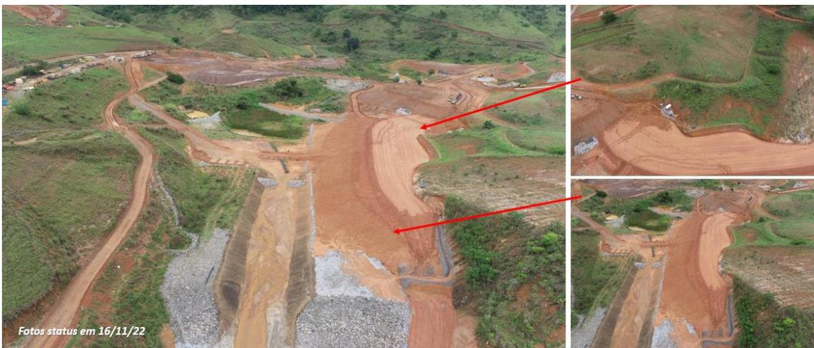
Figura 6 – Disposição de Sedimentos Berma de Equilíbrio
